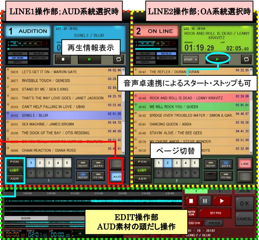
「AUD」システムを選択時、HEAD EDIT画面が表示され、AUD選択素材の波形が表示される。。リモートBOXのJOGを利用して再生開始位置を設定し、設定した再生開始位置から、OA再生が可能となる。録音時には、1TRK録音機能になり、PLAYERで再生しながら録音が可能。
